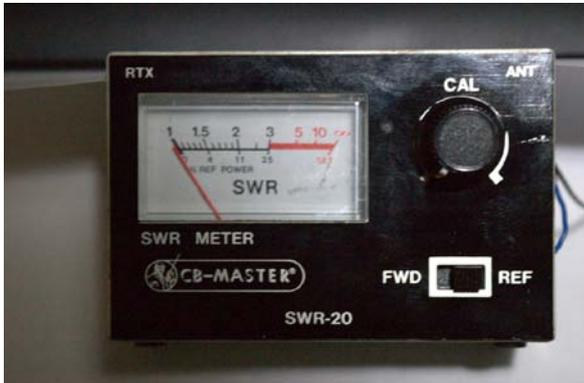
Schon für den ersten Versuch mußte eines dieser billigen, für den CB-Funk gebauten SWR-Meter als „Organspender“ dienen. Jeder, der versucht, die Teile für ein solches Gerät inclusive Gehäuse für einen einstelligen Eurobetrag zu kaufen, wird diese Rechnung verstehen.
